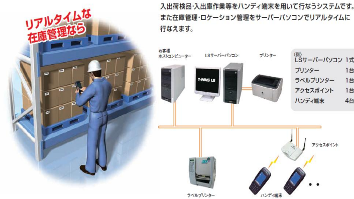
例3 ハンディ端末利用の入出荷・入出庫ロケーション管理システム (基本機能パッケージ+ハンディ端末)
